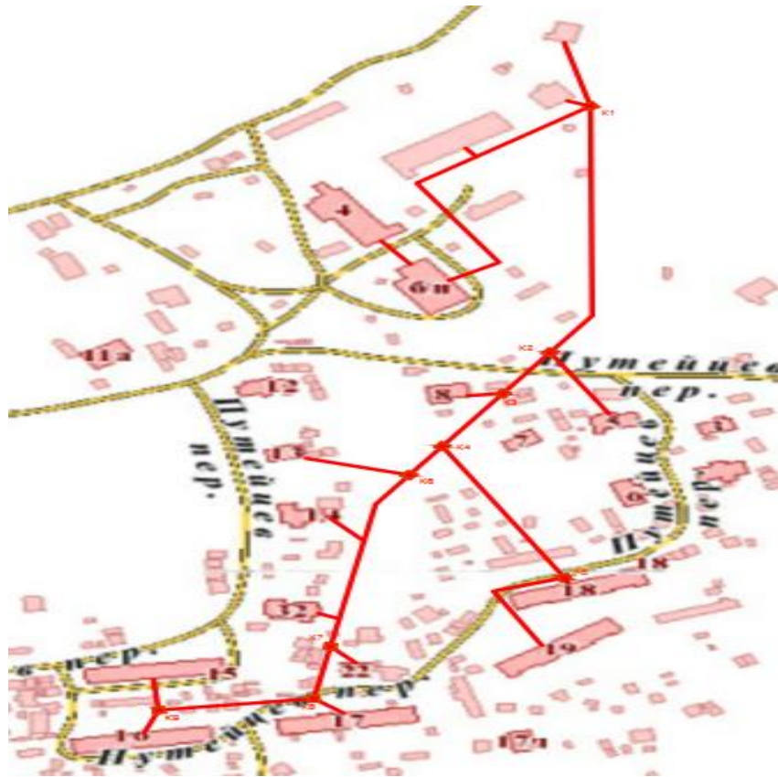
Рис. 2.1 – Зона теплоснабжения котельной, п.Щельюр, ул.Путейцев, 4Б
