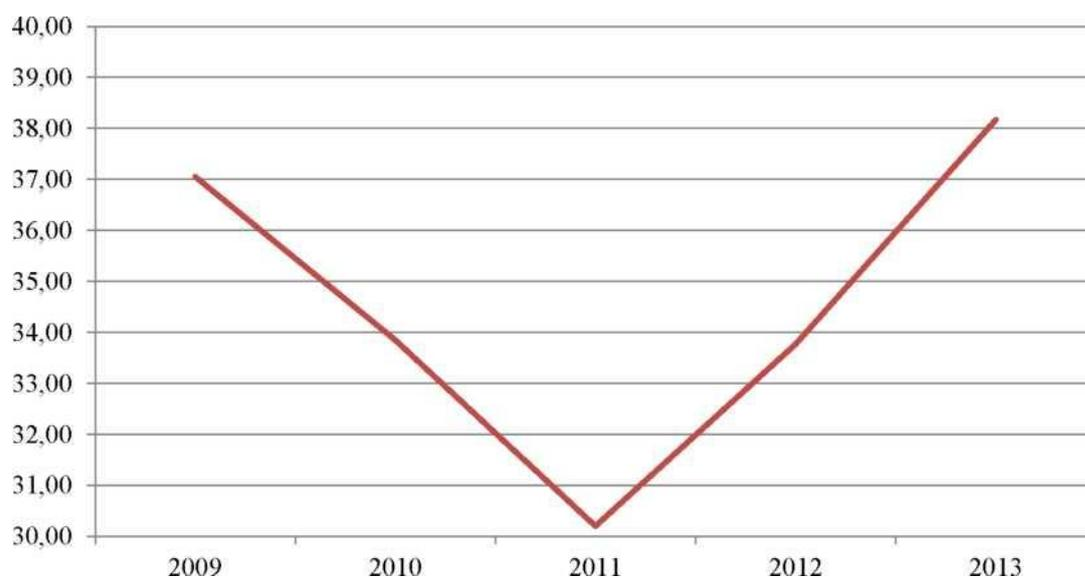
Рисунок 2 - Изменение коэффициента использования теплоты топлива котельной «Школы»
