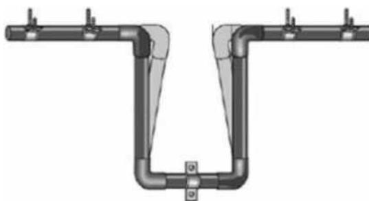
Рисунок 3 - П-образные компенсаторы
