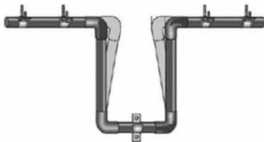
Рисунок 3 - П-образные компенсаторы
