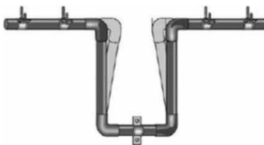
Рисунок 3 - П-образные компенсаторы
