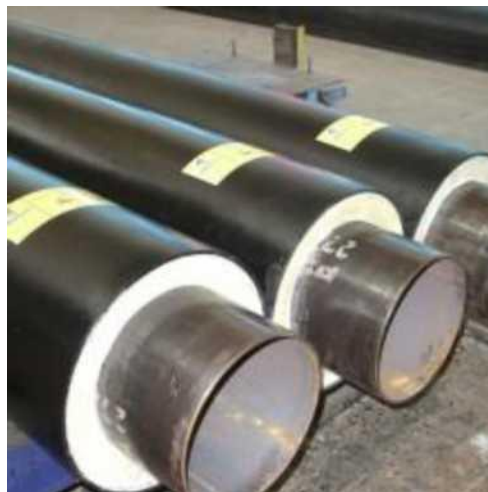
Рисунок 2 - Предварительно изолированные пенополиуретаном трубы
